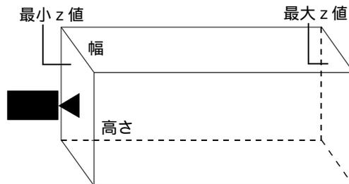
射影変換では、カメラがとらえた空間(ビューボリューム)を「 $X = -1 \sim +1$ 」「 $Y = -1 \sim +1$ 」「 $Z = 0 \sim +1$ 」の領域に収まるように変換します。この空間を射影空間と呼びます。
