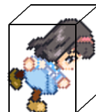
軸に平行、垂直でない形状になると余分な領域が増える
